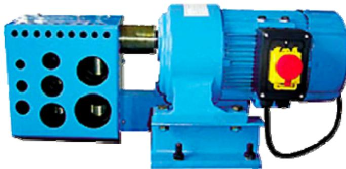
Машина электромеханическая данной серии предназначена для вырезания седловин на торцах труб. Выпускается в модификациях для сетей 220 и 380В частотой 50Гц. Машина обрабатывает трубы диаметром от ¼ до 2 дюймов. Компактная и надежная машина.
